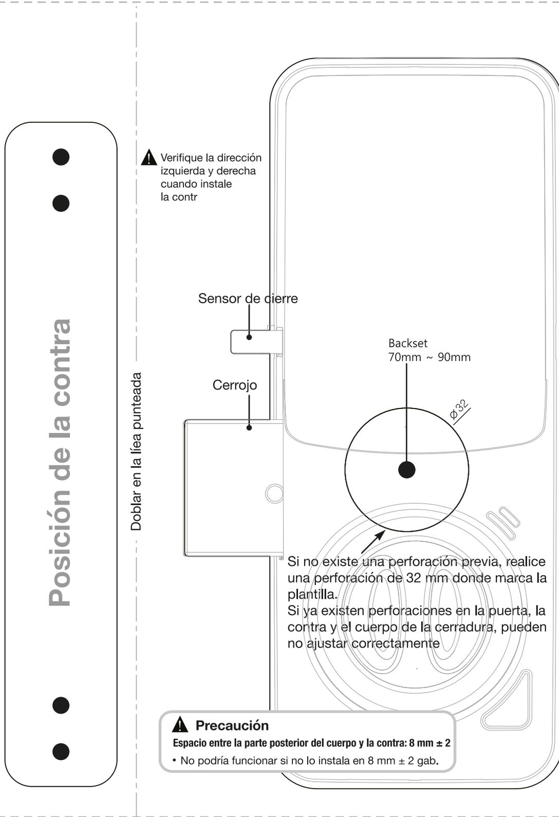
Si no existe una perforación previa, realice una perforación de 32 mm donde marca la plantilla.
